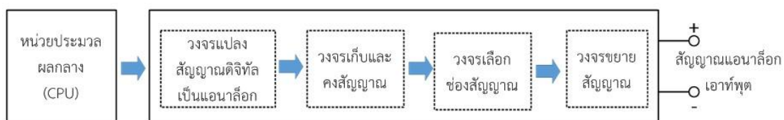
ภาพที่ 3.21 ไตอะแกรมของหน่วยเอาต์พุตแบบแอนะล็อก
