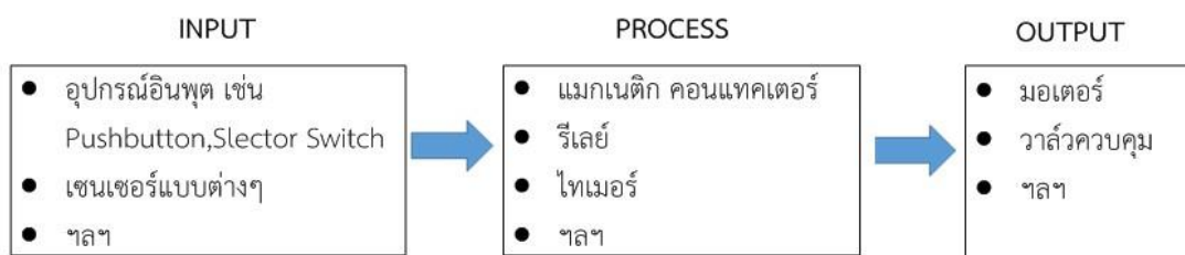
ภาพที่ 1.16 โครงสร้างของระบบควบคุมแบบเก่า
