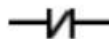
ภาพที่ 6.1.2 สัญลักษณ์ คำสั่ง Normally Closed (NC)
